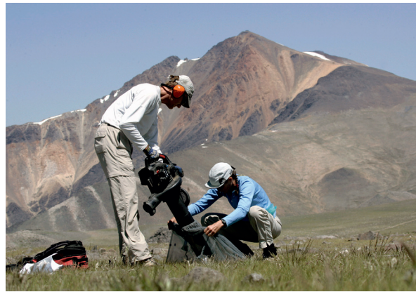
图 7.7 用于节肢动物采样的捕网-真空管法。左：抛出样方；右：通过锥形网顶端有弹性孔用真空泵吸取草丛中的节肢动物。摄影：Lance Iversen, San Francisco Chronicle.
