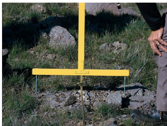
图 7.4 带有两个采样针的针刺器。可对相距 0.5-m 的两个点同时进行针刺观测。
