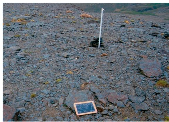
图 4.7 山峰扇区的一个角点。照片为西班牙 Sierra Nevada 的 Pico del Tosal Cartujo 研究点 10-m 点 (p10m-W)，海拔高度 3.150 m a.s.l. 角点上插着标志杆。
